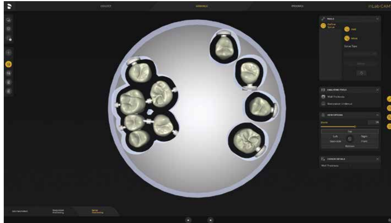
Voll bestücktes Werkstück mit effizienter Materialausnutzung.
