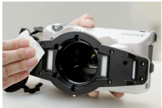
Das rundum glatte Gehäuse der EyeSpecial C-V ist wasser- und chemikalienbeständig und lässt sich schnell und gründlich mit Äthanol sprüh- und wischdesinfizieren. So ist die Kamera nach den aktuellen Hygienerichtlinien bestens für den Praxiseinsatz vorbereitet.
