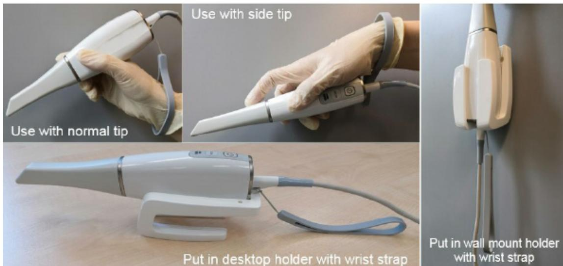
Es wird empfohlen, beim Scannen die Handschlaufe zu verwenden, um ein versehentliches Herunterfallen des Scanners zu vermeiden.
