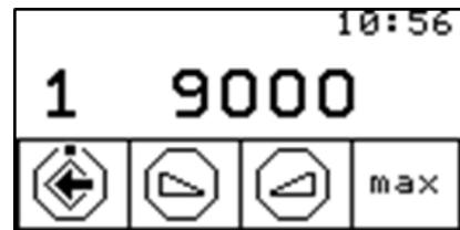
Einstellmenü für minimale/maximale Drehzahl
